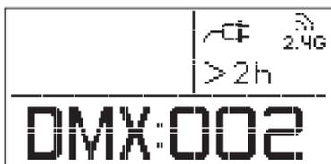
DMXモードでは【Brightness】ダイヤルを回してDMXチャンネルを設定します。
