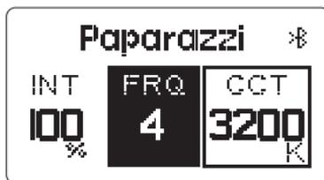
色温度設定を変えるにはFXモードで【CCT】ダイヤルを回して色温度を2700K～6500Kに設定出来ます。
